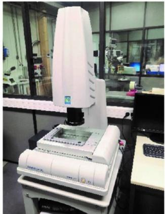
← Une première au mois de Janvier, une machine de **contrôle 3D optique automatique « Microvu »**. Nous effectuons des mesures tridimensionnelles sans contact.
